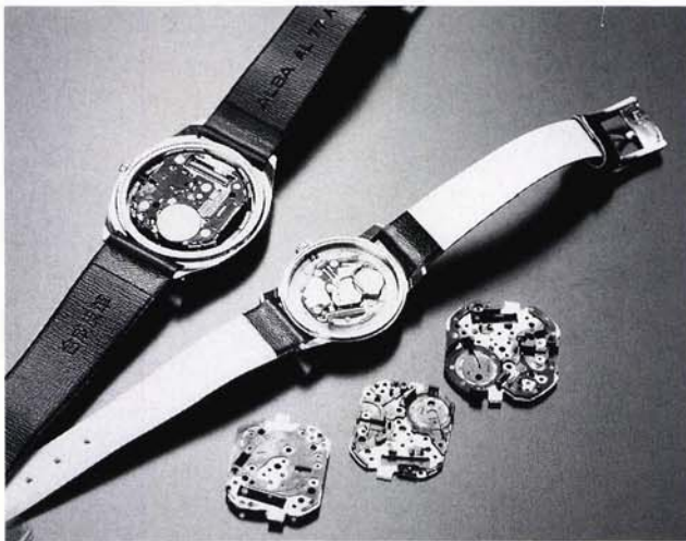
写真(3)ー4 腕時計のメカニカルパーツ及びギア(POM)
