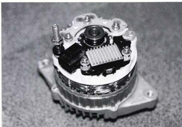
写真(1)-28 オルタネーターのブラシホルダー(GF/フィラー強化PPS)
