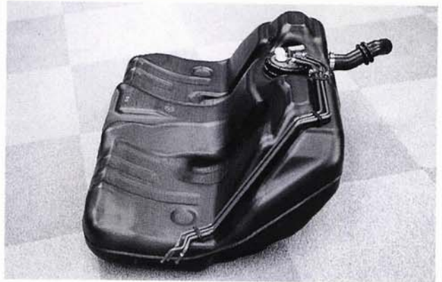
写真(1)-20 3種5層ガソリタンク(HDPE/接着層/PA/接着層/HDPE)
