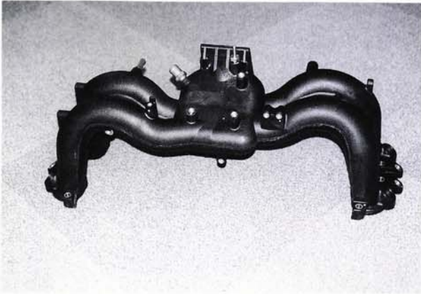
写真(1)－6 エアインテークマニホールド ブロー成形品(GF強化PA6)
