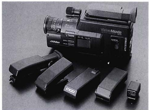
写真(2)-12 VTR カメラ／鏡筒部(GF 強化 PC)
