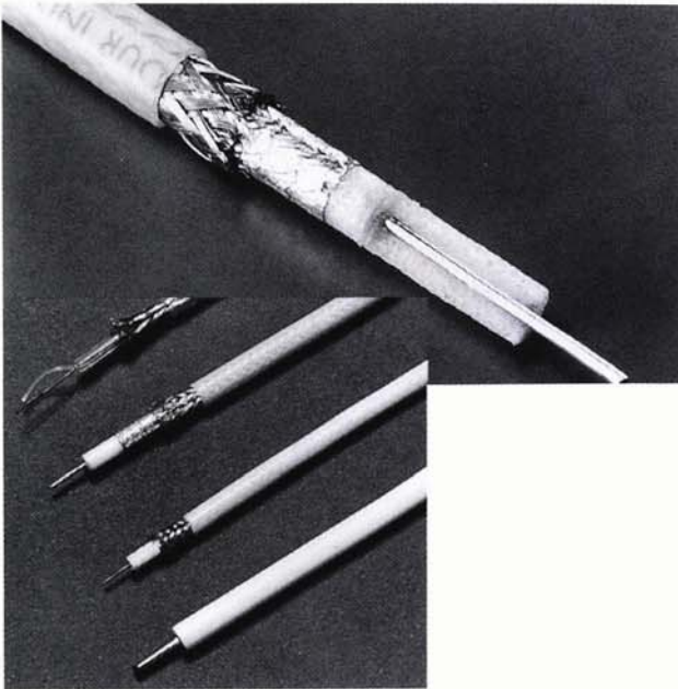
写真(2)-50 ケーブル被覆材料(PTFE/FEP)
