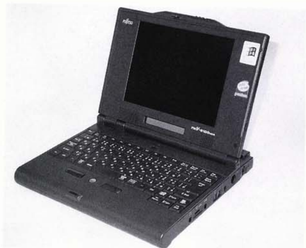
写真(2)-56 パソコン/ハウジング(GF、MD 強化 PA)
