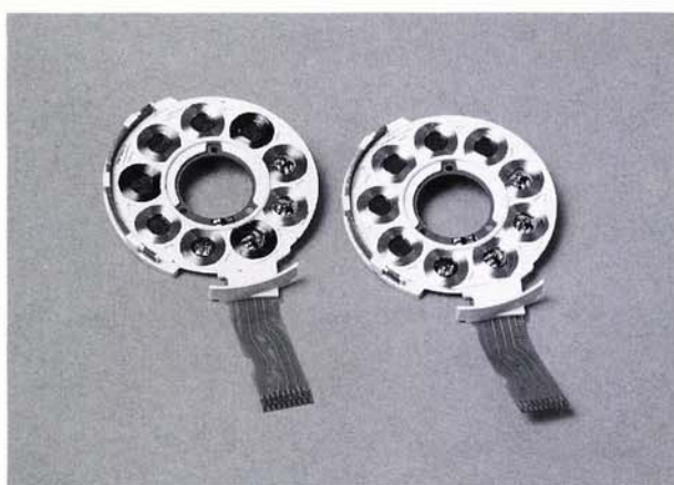
写真(2)-14 VTR/モーターのステーター(LCP)
