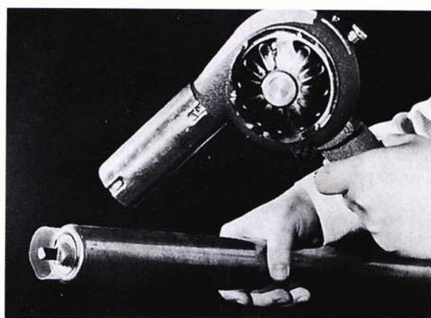
写真(8)－5 ロールカバー熱収縮チューブ(FEP)
