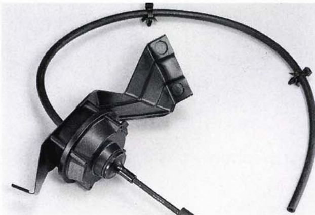
写真(1)-19 オートドライブアクチュエーターケース (GF 強化 PBT)
