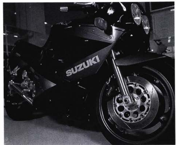
写真(1)-54 モーターバイクカウリング(GF 強化 PA)
