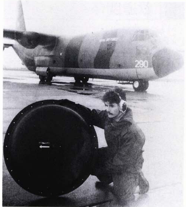
写真(1)-57 レーダーアンテナのレドーム(PES)
